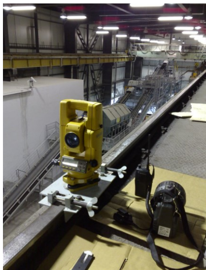
Obr. 2 Upevnění UMS měřicí stanice na kolejnici
