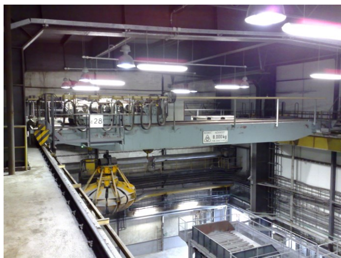
Obr. 5 JD v hale odškvárování brněnské Spalovny komunálního odpadu
